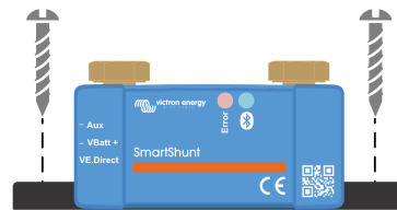
Vue de haut du SmartShunt IP65 montrant les orifices de montage et Vue latérale du SmartShunt indiquant la méthode de montage.
